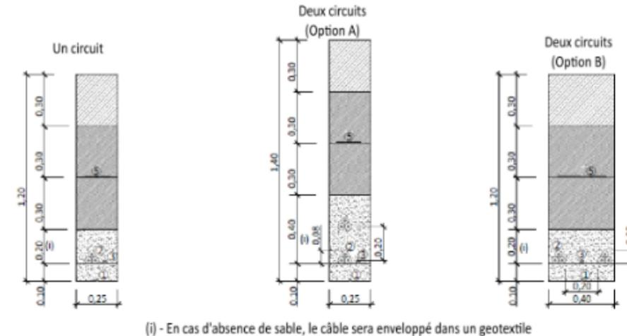
(i) - En cas d'absence de sable, le câble sera enveloppé dans un geotextile
